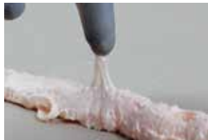
Lijm trekt draden bij aanraking: optimale kleefkracht
